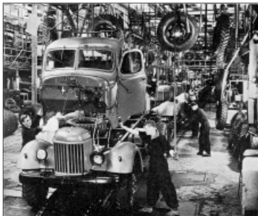
Ennen vallankumousta Venäjällä ei ollut omaa autoteollisuutta. V. 1924 Moskovan myöhemmin Lihatsheville omistettussa autotehtaassa valmistettiin ensimmäiset kuorma-autot. Kuvassa tehtaan kokoonpanolinja.
